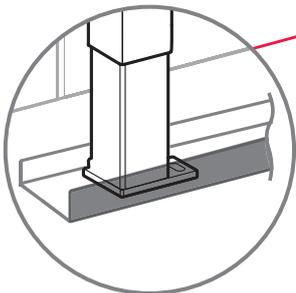
Verwendung eines UW-Trockenbauprofils als Bodenschiene erleichtert die fachgerechte Trockenbaubeplankung.
