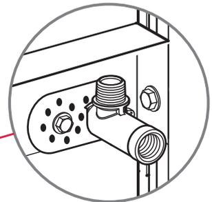
Wasseranschlüsse entsprechend der zu verwendenden Keramik einsetzen.
