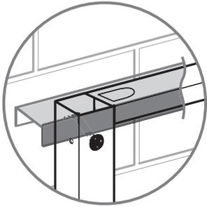
Befestigungsbolzen entsprechend den Maßen des Keramikherstellers einsetzen.
